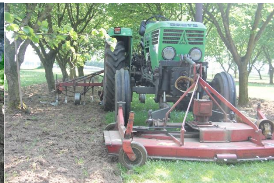
Figuur 16 & 17 Met de aangepaste schoffelmachine van Harm is het mogelijk om telkens de helft van de zwartstroken te schoffelen. Dankzij het extra mes op de zijkant (blauwe cirkel) wordt ook de strook tussen de bomen meegenomen. Bij een boom klapt het mes automatisch in waardoor de bomen niet beschadigd worden.
