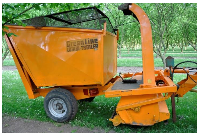
Figuur 20 De klepelwagen wordt gebruikt om takken, snoeimateriaal en oogstresten op te rapen en te klepelen waarna ze kunnen gecomposteerd worden samen met het maaisel van de grasstroken.
