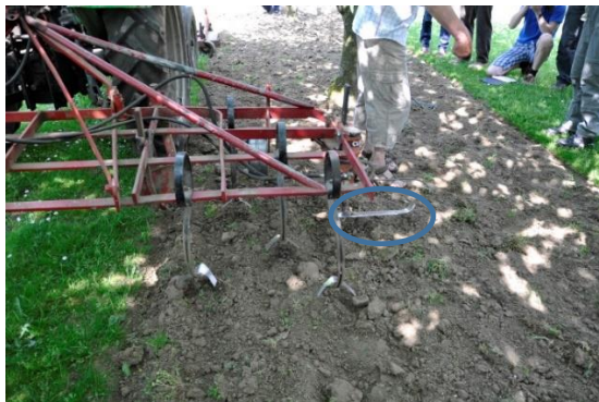
Figuur 16 & 17 Met de aangepaste schoffelmachine van Harm is het mogelijk om telkens de helft van de zwartstroken te schoffelen. Dankzij het extra mes op de zijkant (blauwe cirkel) wordt ook de strook tussen de bomen meegenomen. Bij een boom klapt het mes automatisch in waardoor de bomen niet beschadigd worden.
