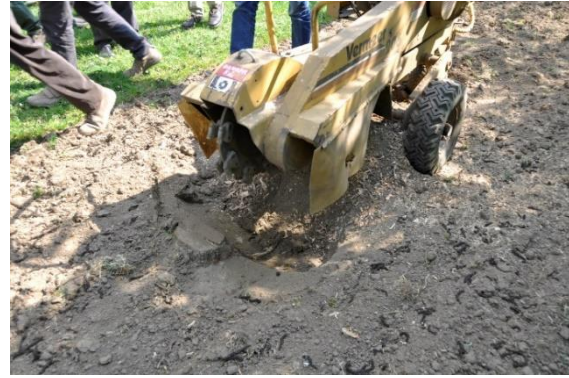
Figuur 14 & 15 De stobben werden verwijderd met een stobbenfrees zodat de stook over gans de breedte makkelijk te maaien en te onderhouden is.
