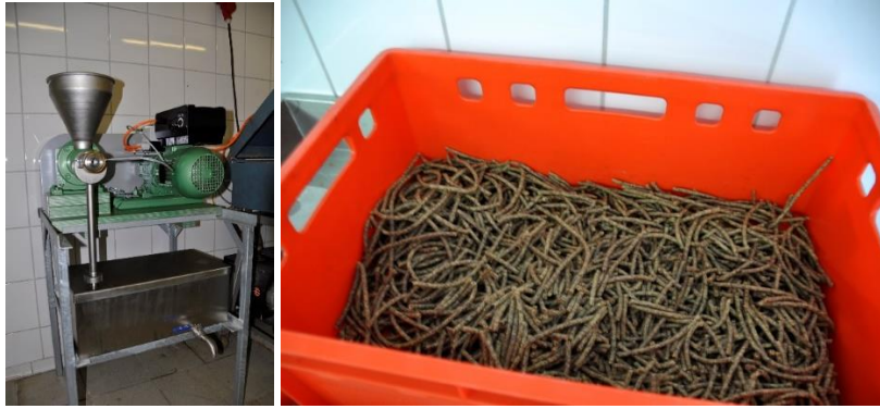
Figuur 45 & 46 Links: Kleinschalige pers voor de productie van olie uit noten en zaden. Rechts: Het restproduct is de perskoek en gaat naar een lokale patissier die deze gebruikt voor de verwerking in taarten en gebak.
