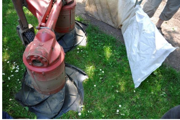
Figuur 29 Zelf ontwikkelde machine waarmee de noten door twee ronddraaiende rubberen vegers in een rij op de zwartstrook worden verzameld.
