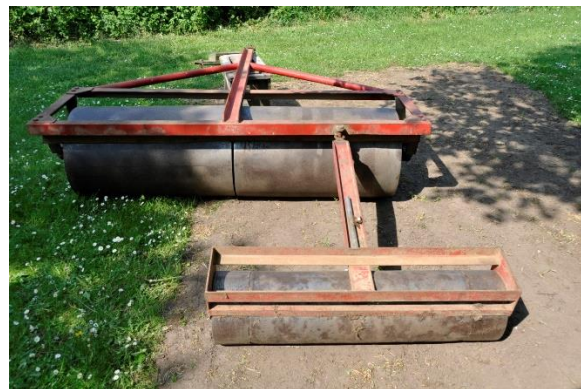
Figuur 28 Systeem met dubbele rol om zwartstroken goed te effenen vooraleer de start van het oogstseizoen.
