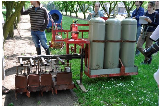
Figuur 19 Eigen ontwikkelde onkruidbrander gebruikt om de zwartstroken onkruidvrij te houden tijdens de zomer.
