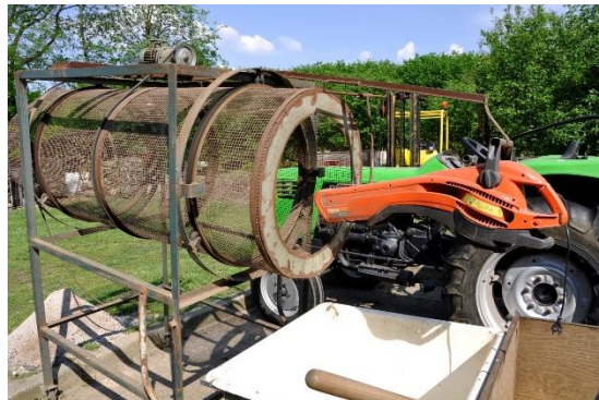
Figuur 30 Met behulp van deze simpele opstelling van een cilindervormige zeef, bladblazer en een bak met water worden de noten gereinigd.
